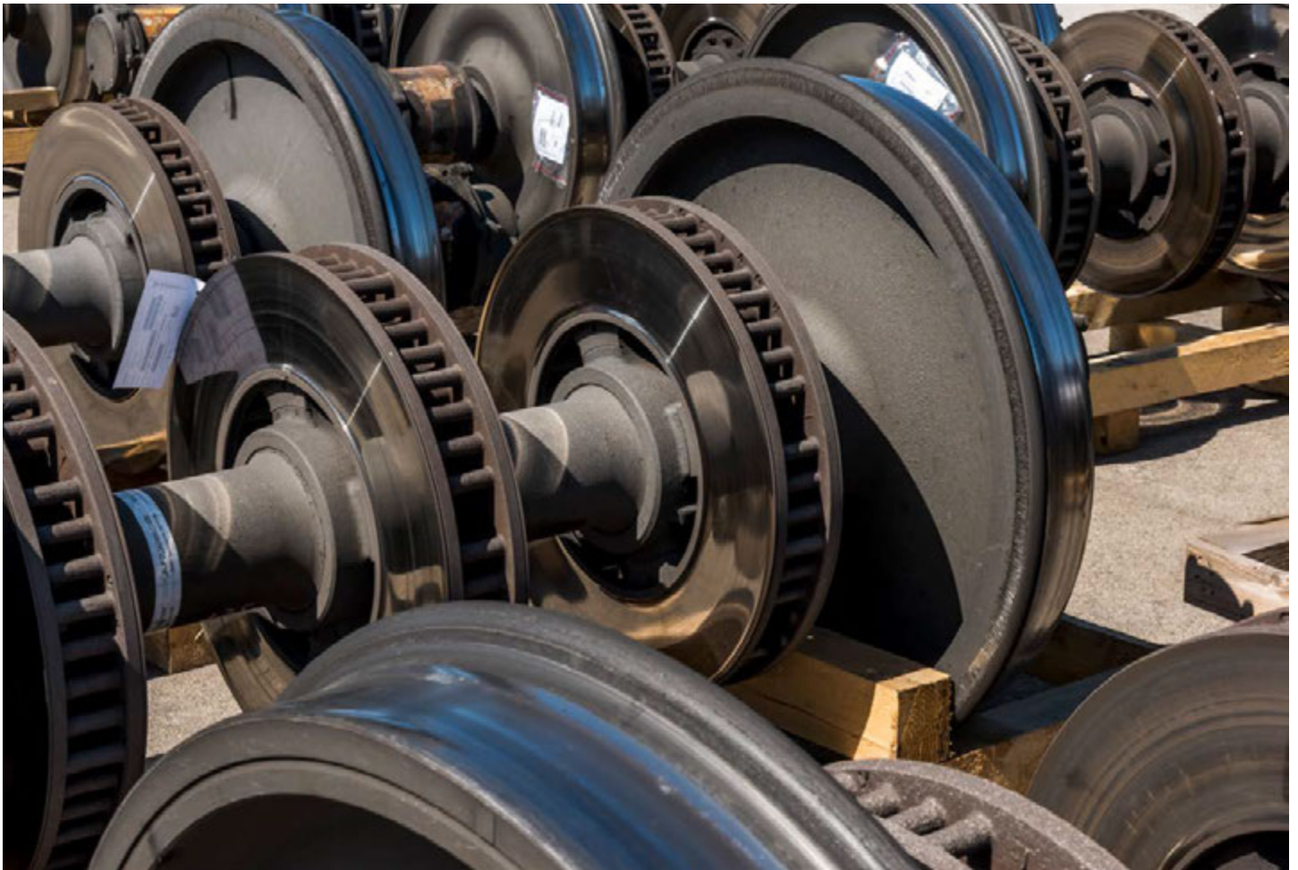
BEI DEN ÖBB-TECHNISCHE SERVICES werden 580.000 Komponenten von Schienenfahrzeugen – wie zum Beispiel Laufradsätze – wieder aufgearbeitet
