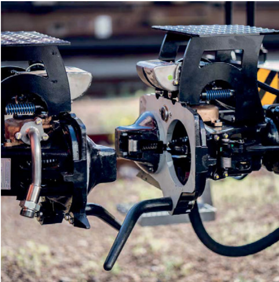
DAK. Die digitale automatische Kupplung soll den Schienengüterverkehr revolutionieren
