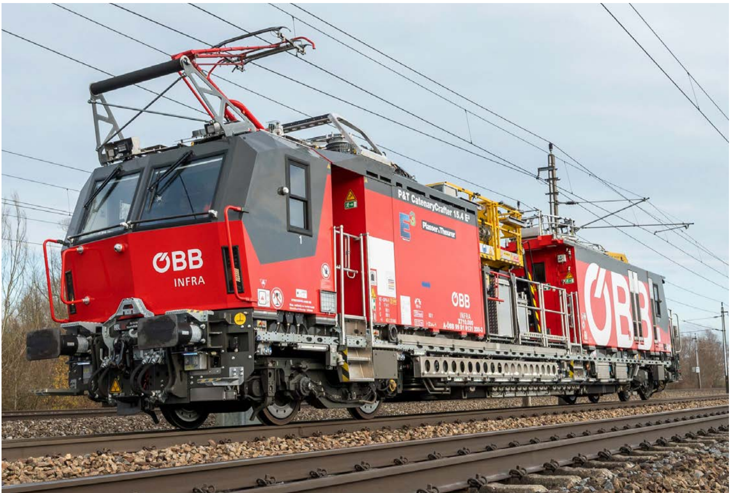
EINSATZFAHRZEUGE. Neue und hochmoderne Hybrid- ersetzen dieselbetriebene Instandhaltungsfahrzeuge
